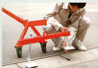
③必ずフタの中心に本機を設置。 フタの巾に合わせて引っ掛け棒をスライド調整する。
