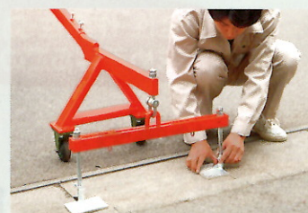
④引っ掛け棒を手掛け部の穴へ挿入し、フタの下まで下りてくることを確認後、振れ止板を下げて棒を90度回転させる。
