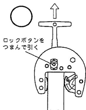
⚠️ 吊り上げ方向は必ず垂直方向に上げて下さい。斜め方向からの吊り上げは厳禁!
