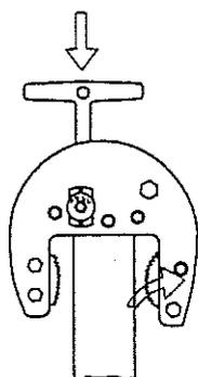
⚠️ 必ずカチッと音が鳴るまでハンドルを下げしてから吊具を吊上げて下さい!
